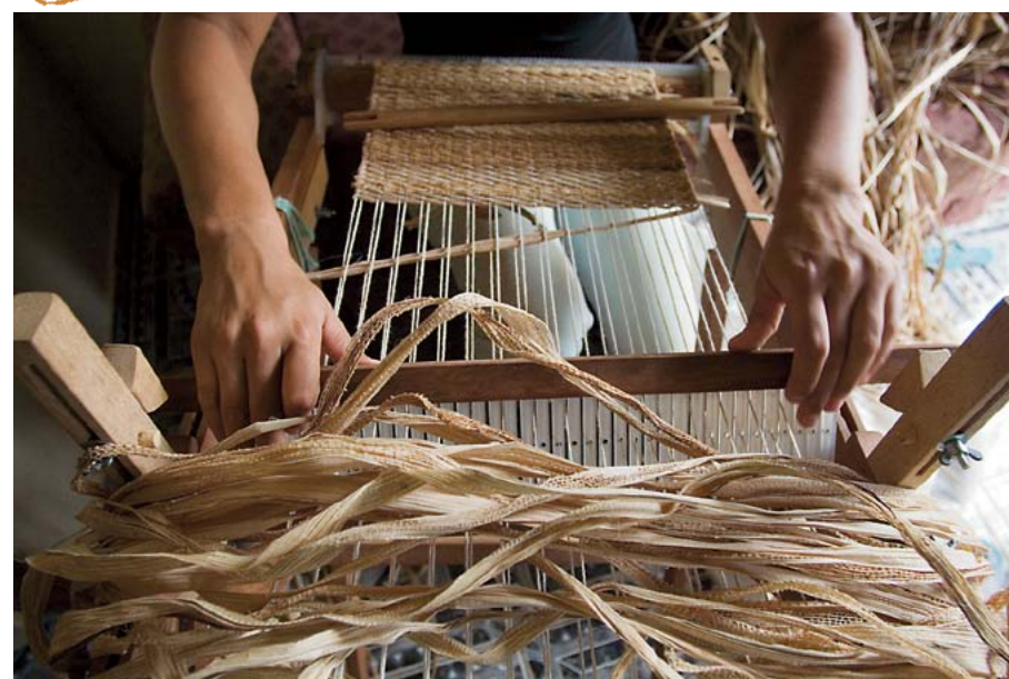
Tear utilizado para tecer fibra de bananeira. © Felipe Leal/ISA, 2006
